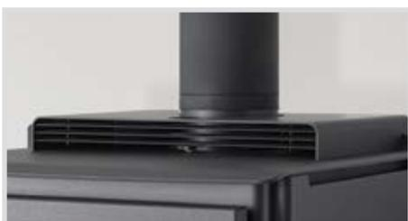
Le convecteur Airmate recueille l'air très chaud situé à l'arrière et au-dessus du poêle pour le faire circuler à l'avant dans la pièce. Cette répartition de chaleur réduit la température à l'arrière de l'appareil et permet de placer ce dernier plus près d'un mur.
