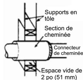
Dégagement minimal de 2 po (51 mm) de la cheminée aux supports en tôle et matériaux combustibles
