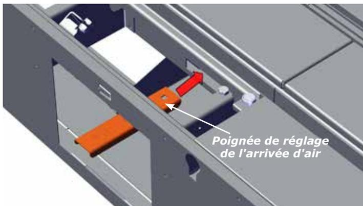
**Remarque :** La poignée d'arrivée d'air se trouve à la droite de la trappe d'accès de la valve de gaz. Elle est maintenue par un aimant.
