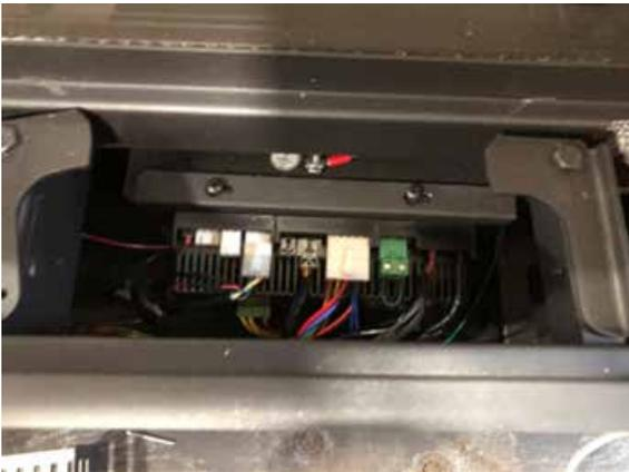
3. Localiser le raccordement de la clé électronique WiFi (X0A) sur le côté gauche du IFC.
