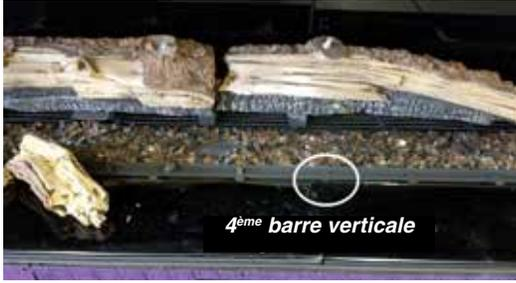
14. Installer la bûche 8 : le noeud sur la bûche doit reposer sur la 2<sup>nd</sup>e ligne verticale en partant de la droite, à l'avant du brûleur et l'extrémité gauche de la bûche doit reposer à 1 po de la bordure du panneau. L'extrémité droite de la bûche 8 doit être située à 2-1/2 po du rebord droit du brûleur.
