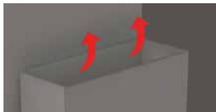
L'ouverture de ventilation peut être placée sur le dessus en s'assurant qu'elle respecte l'ouverture de 288 po<sup>2</sup>. Ce type d'ouverture de ventilation est utilisé lorsque le haut de l'enceinte est visible d'en haut et lorsque le plafond de la pièce est plus haut que la normale.
