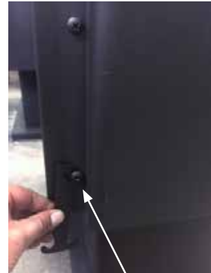
Dévisser la vis puis insérer la fixation du levier.
