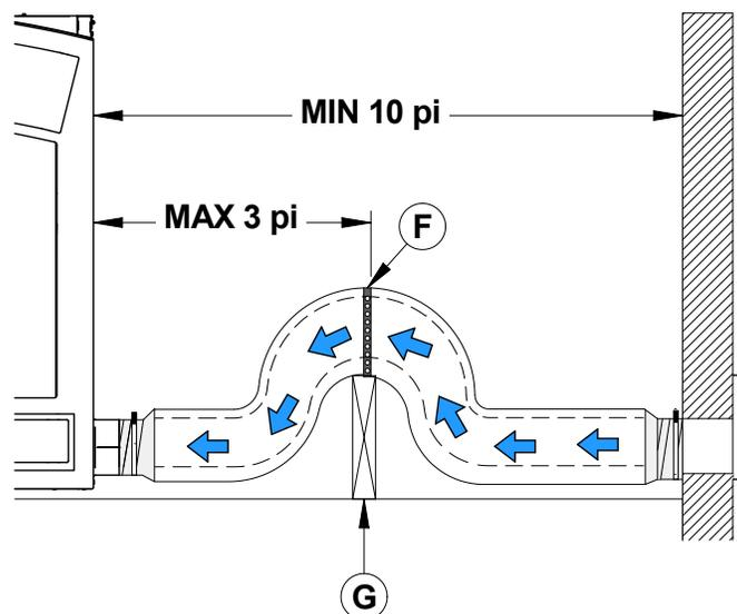
**Il est fortement recommandé d'installer un clapet mécanique étanche permettant de fermer l'entrée d'air extérieur lorsque le foyer n'est pas utilisé.**
