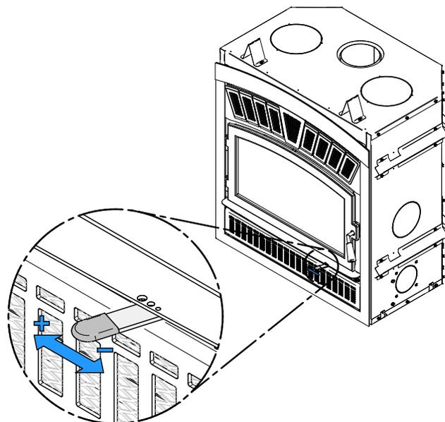
D'autre part, trop d'air peut rendre le feu incontrôlable, créant des températures très élevées dans l'appareil ainsi que dans la cheminée et les endommager sérieusement. Une lueur rougeâtre sur l'appareil et sur les composants de la cheminée indique une surchauffe. Des températures excessives peuvent provoquer un feu de cheminée.
