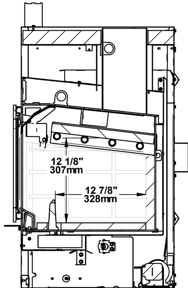
Figure 9: Chambre à combustion - Vue de côté
