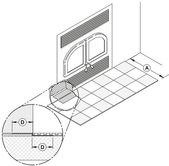
Lorsque le foyer est installé directement sur le plancher, une protection de plancher incombustible d'au moins 16" (**A**) avec un facteur R de 1.00 doit être installée en face du foyer. Le joint entre la protection de plancher et le foyer doit être protégé par une tôle de métal pliée et continue sur toute la largeur de la protection de plancher (**D = min 2" [51 mm]**) (non fournie).
