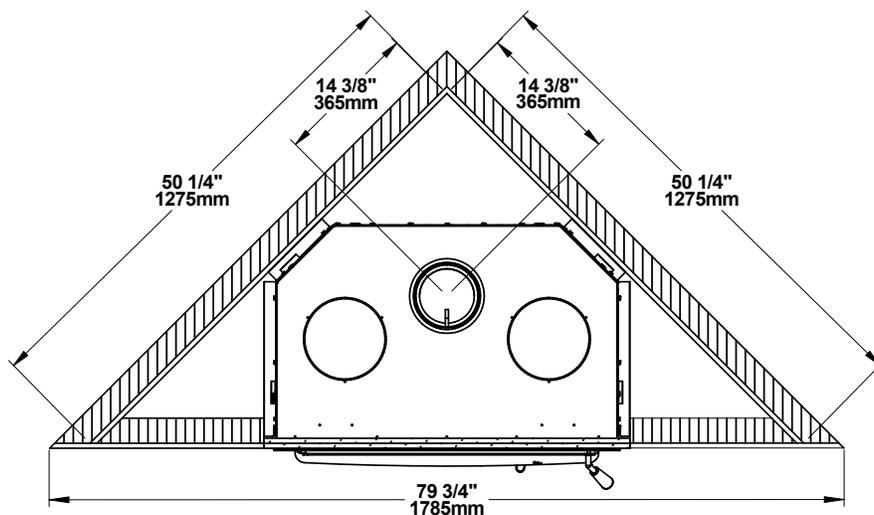
*La configuration du châssis doit être utilisée comme référence seulement.* Si un matériau de finition est installé à l'intérieur de l'enceinte, son épaisseur doit être ajoutée aux mesures suivantes.
