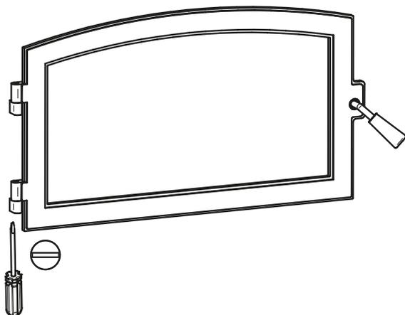
À l'aide d'un tournevis plat, tourner les tiges de pentures ajustables dans les sens indiqués pour ajuster les portes. Resserrer les vis de pression sur les gonds de porte lorsque ces dernières sont aux positions désirées.
