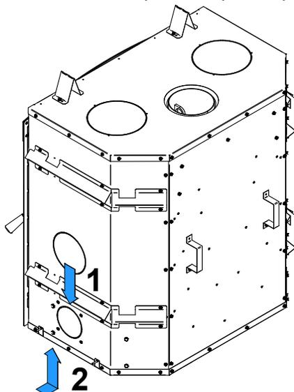
L'ensemble d'entrée d'air frais peut être installé à deux endroits différents sur le foyer. Sur le côté droit **(1)** de l'appareil (le plus commun) ou sur le côté droit sous l'appareil **(2)**.
