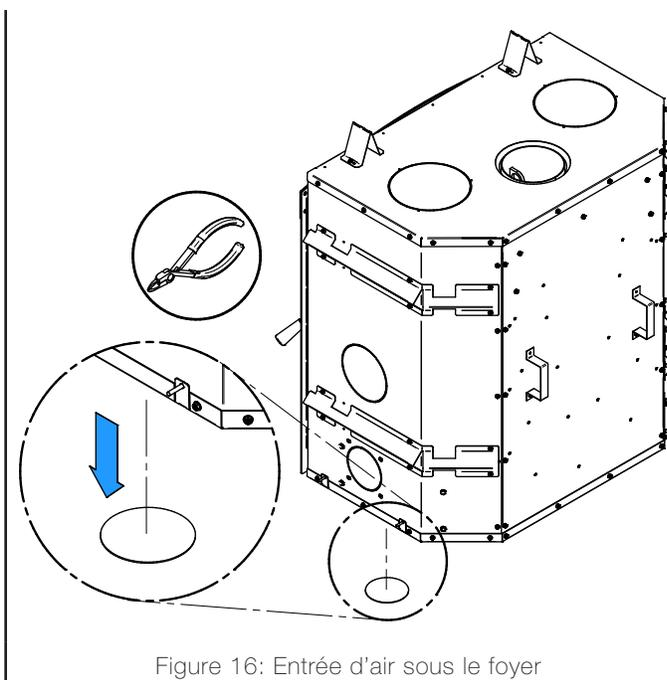
Figure 16: Entrée d'air sous le foyer
