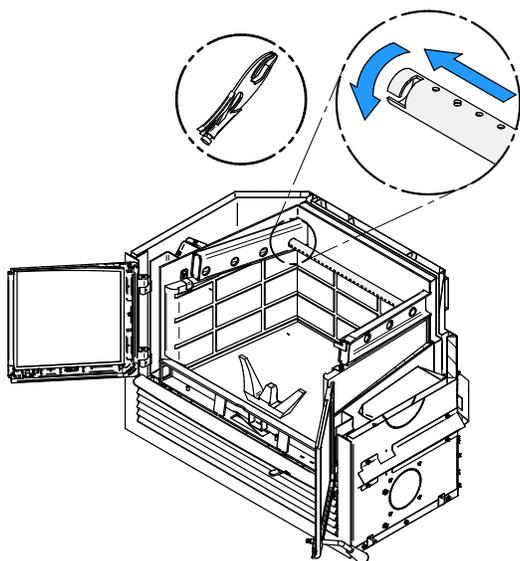
2. Aligner le chemin du tube et la dent dans le trou de la canalisation. Tenir le tube à l'aide d'une pince de serrage et suivre le mouvement décrit dans la figure ci-contre pour le sécuriser en place. S'assurer que la dent touche le fond du chemin du tube.
