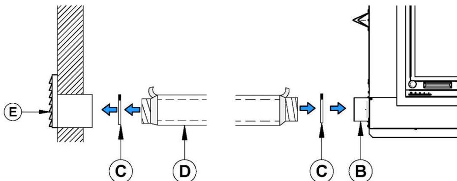
\*Pour un conduit de moins de 20 pieds, utilisez un conduit de 5". Pour un conduit de plus de 20 pieds, ou ayant plus de deux déviations, utilisez un conduit de 6". Le conduit doit avoir maximum 30 pieds (9 m).
