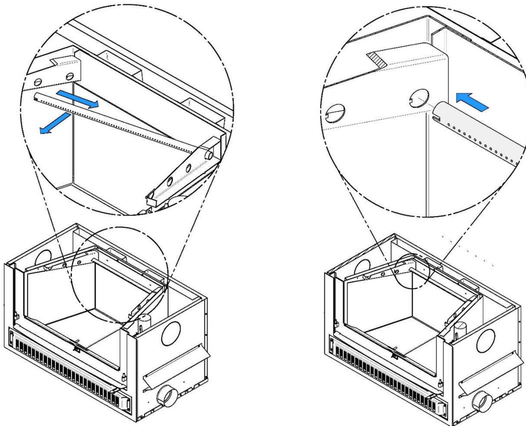
5. Insérer une goupille de rétention dans le dernier trou à droite du tube. Déplier ensuite les pattes de la goupille afin qu'elle demeure en place.
