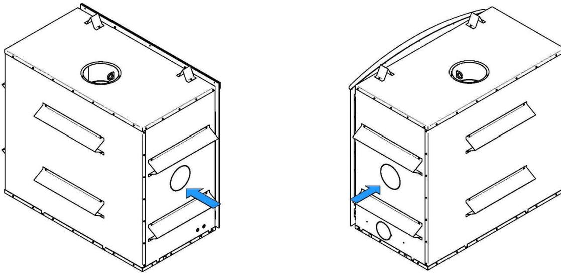
Cet ensemble permet de distribuer la chaleur vers une autre pièce jusqu'à 50 pieds (15 m) du foyer. Le tuyau isolé flexible (non compris dans l'ensemble) doit être de type HVAC et être conforme aux normes ULC S110 et/ou UL 181, classe 0 ou classe 1 et doit résister à des températures allant jusqu'à 250°F.
