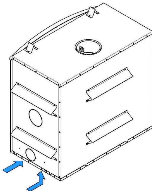
1. Retirez le disque détachable situé sur le côté droit de votre foyer en coupant les micro-joints.
