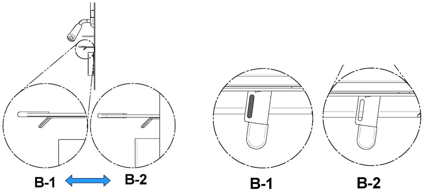
Dans la position B, il est possible de fermer manuellement l'admission d'air, en cas de panne de courant, en poussant la petite clé vers la gauche.
