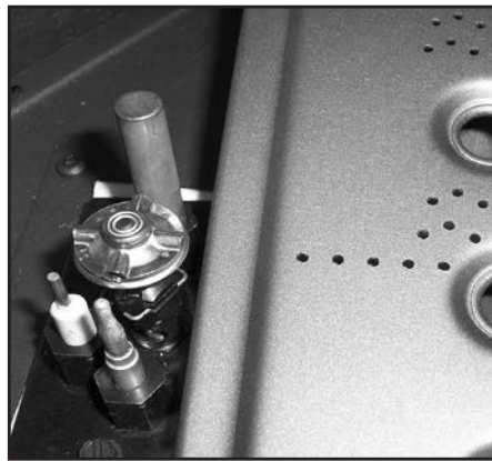
Figure 13: Assemblage de Ignitor côté du brûleur.
