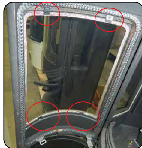
Fixations de la porte vitrée avant
