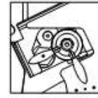
Position correcte des flammes de veilleuse
