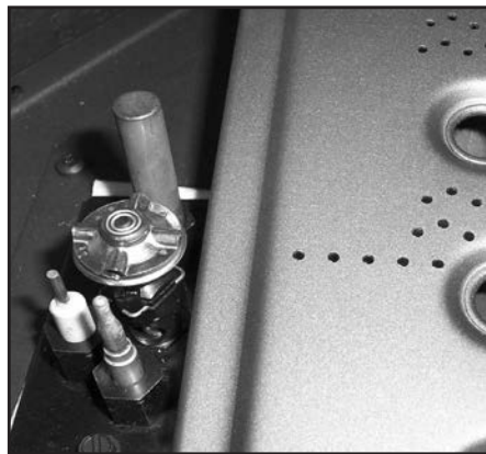
Figure 15: Assemblage de l'allumeur à côté du brûleur.
